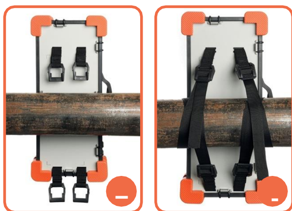
Рис. 6.1. Установка детектора на трубу.
