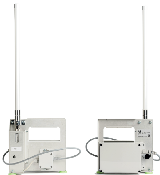
Рис. 7. Переносная точка доступа Wi-Fi с антенной и подключенной батареей питания.
