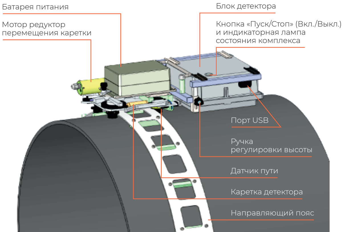
Рис. 1. Компоненты комплекса, смонтированные в месте расположения сварного соединения для контроля по схеме «панорамно».
